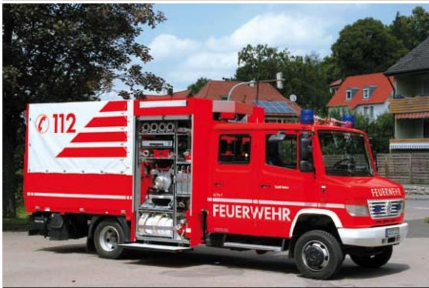
**oben:** Hensel realisierte den GW-Logistik auf einem MB Vario 816 DA mit Allradantrieb.
